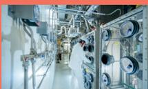
Orano Malvésí réalise la 1<sup>re</sup> phase de conversion consistant à purifier le minerai d'uranium naturel en provenance des mines en tétrafluorure d'uranium (UF4).
